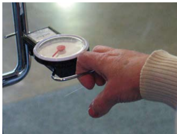
Kuva 1. Oven avaamiseen tarvittava voima mitataan jousivaa'alla. (Kuva: AR)
