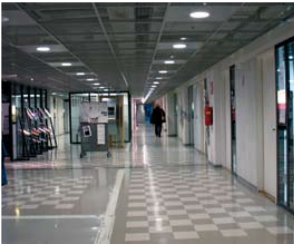
Kuva 8. Käytävän yläpuolinen valaisinrivi toimii ohjaavana elementtinä muuten vaikeasti hahmotettavalla käytävällä. (Kuva: AR)
