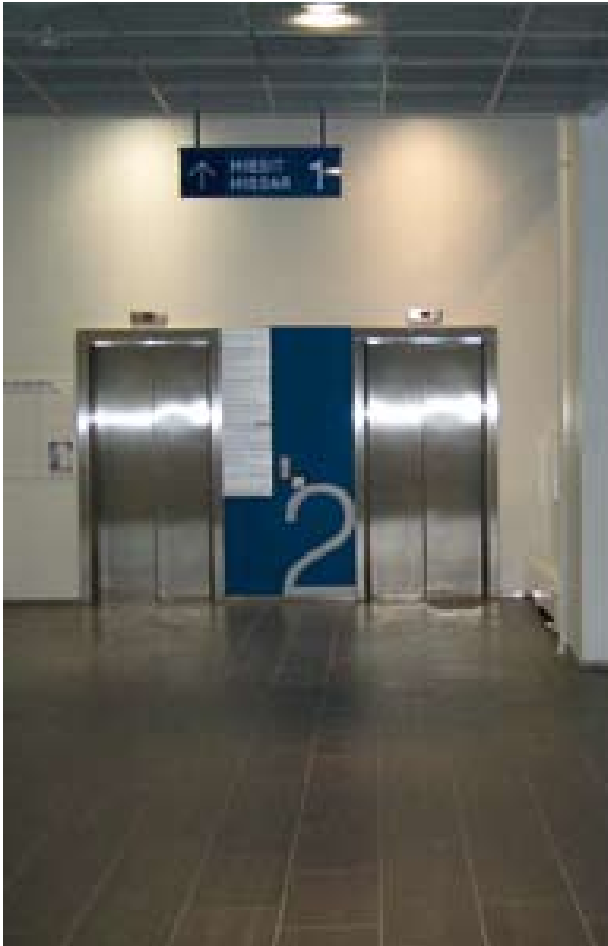
Kuva 17. Kerrosmerkintä erottuu selkeästi taustastaan. (Kuva: AR)
