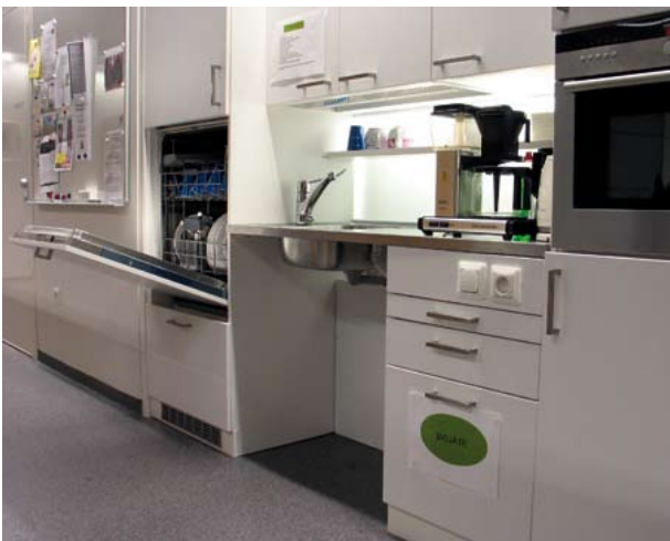
Kuva 78. Esteettömässä keittiöpisteessä tiskipöydän alla on vapaata polvitilaa, astianpesukone on täytettävissä kumartumatta ja jääkaap- peja on kahdella korkeudella. (Invalidiliiton esteetön toimitalo, Helsinki. Kuva: AR)
