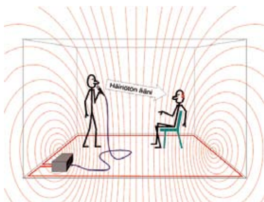
Kuva 5. Induktiosilmukan toimintaperiaate. (Kuva: JR)
