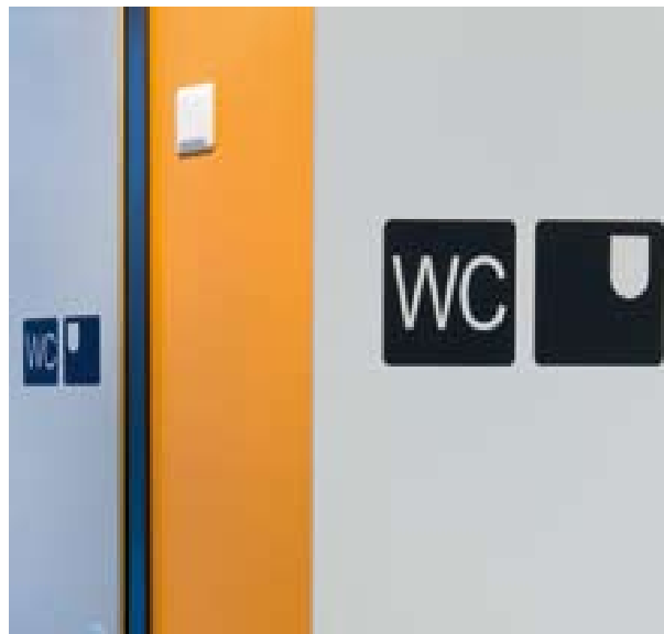
Kuva 80. Peilikuva wc:n symbolit kertovat wc-istuimen sijainnin tilassa eli sen onko wc-tila käytettävissä oikea- vai vasenkätisesti. (Kuva: TP)
