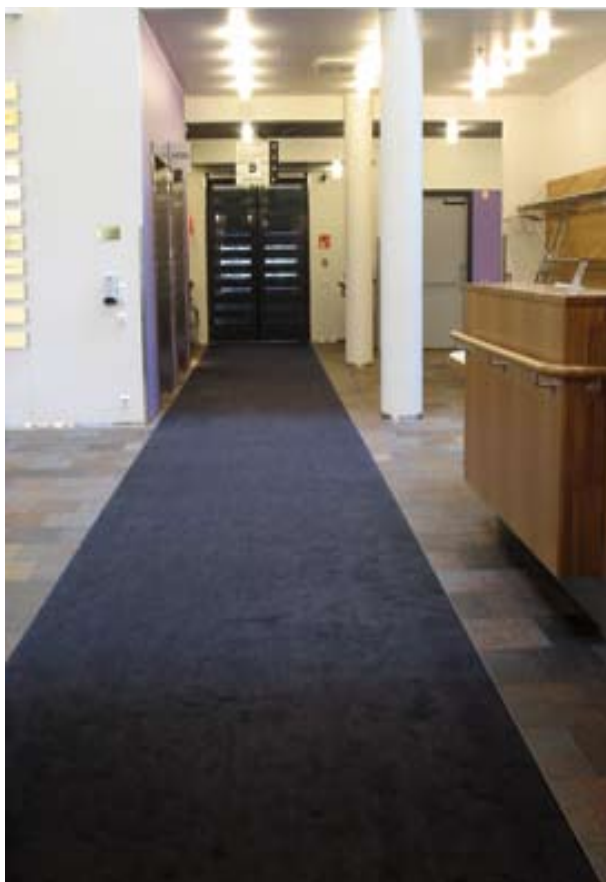
Kuva 73. Käytävänmatto toimii ohjaavana raitana palvelutiskille sekä hisseille. (Invalidiliiton esteetön toimitalo, Helsinki. Kuva: AR)
