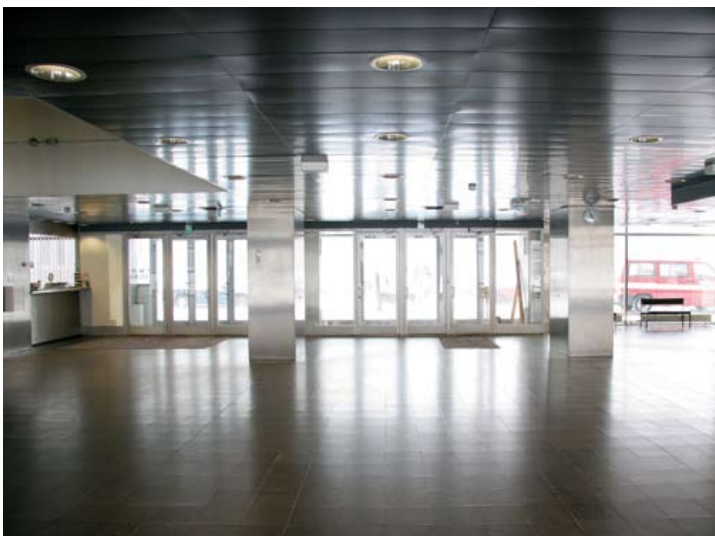
Kuva 12. Syvässä huonetilassa lasiseinä ja kiiltävä lattia aiheuttavat hankalan vastavalohäikäisyn. (Kallion virastotalo, Helsinki. Kuva: JH)
