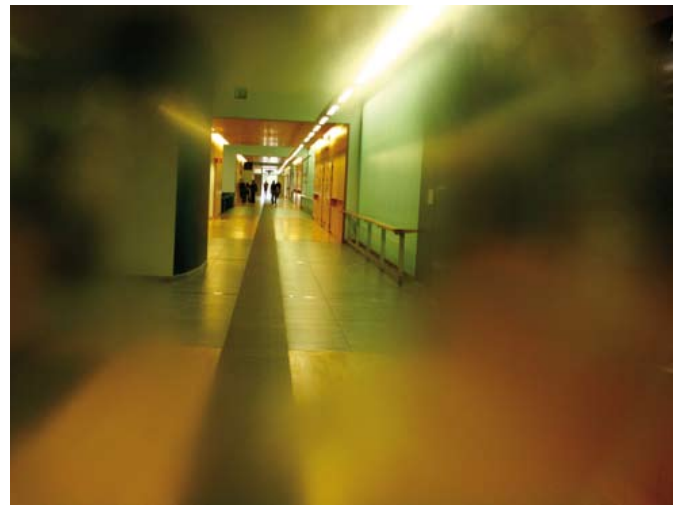
Kuvat 25 ja 26. Selkeä lattiamerkintä ja yhtenäinen valaisinrivi katossa toimivat ohjaavina elementteinä ja tukevat näkövammaisen henkilön itsenäistä liikkumista. (Kuvat ja kuvankäsittely: JS)
