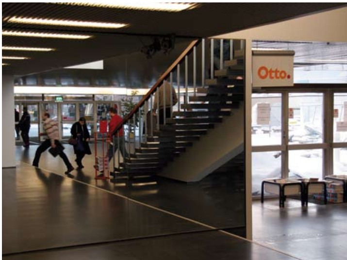
Kuva 10. Peiliseinä saattaa aiheuttaa vaikutelman kulkuaukosta. (Tampereen yliopisto. Kuva: JH)
