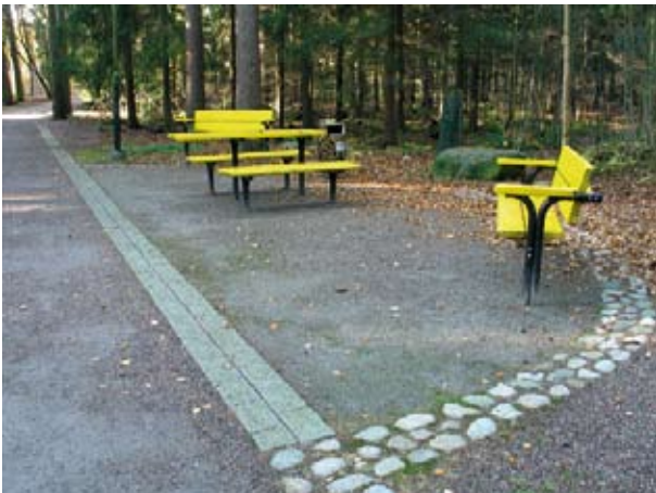
Kuva 42. Levähdyspaikka on sijoitettu kulkuväylän ulkopuolelle ja kalusteet erottuvat tummuuskontrastin avulla ympäristöstä. (Maunulan vanhusten polku, Helsinki. Kuva: AR)
