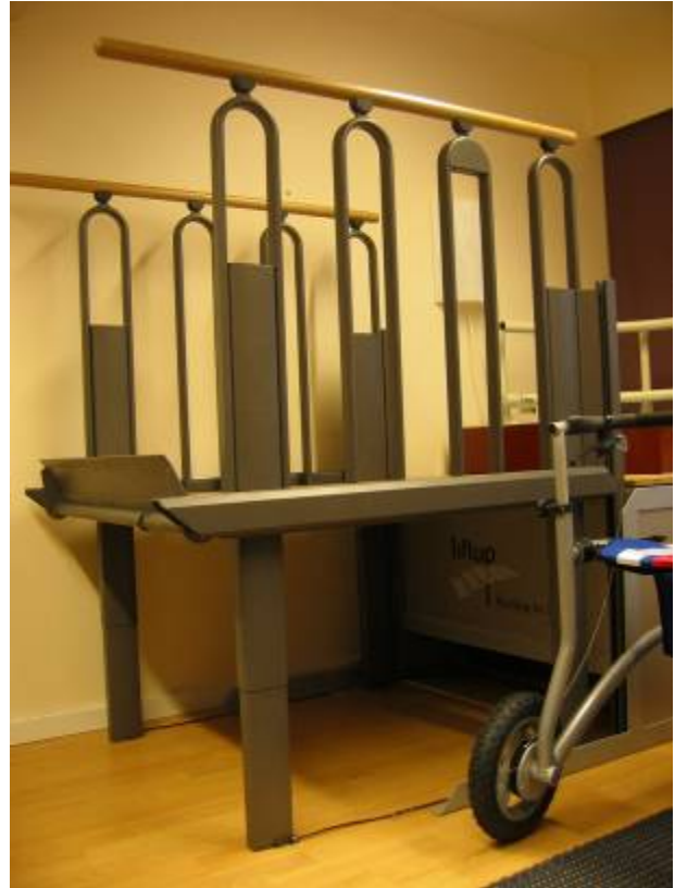
Hissitoiminnon lisäksi taso voidaan muuntaa portaiksi (ks. seuraava kuva).
